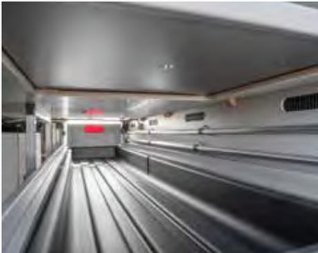
**Stauwanne** von beiden Seiten und von innen zugänglich. Zum Beladen der integrierten Euro-Boxen bzw. der feuchtigkeitsgeschützten Bodenwanne.
